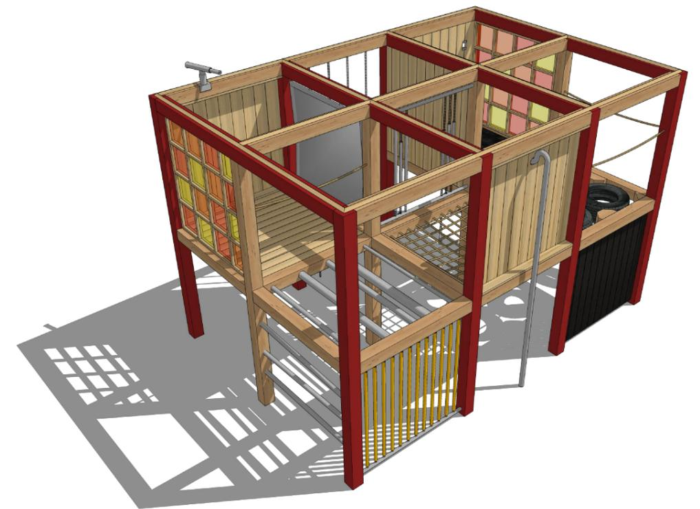
Maximale freie Fallhöhe des Gerätes: 1,42m
