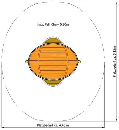
Sitzpodest ca. 2,14 x 1,31m, h= 0,30m mit Bodenbelag aus Robinienbrettern und Stahlrohrrahmen aus Edelstahl
