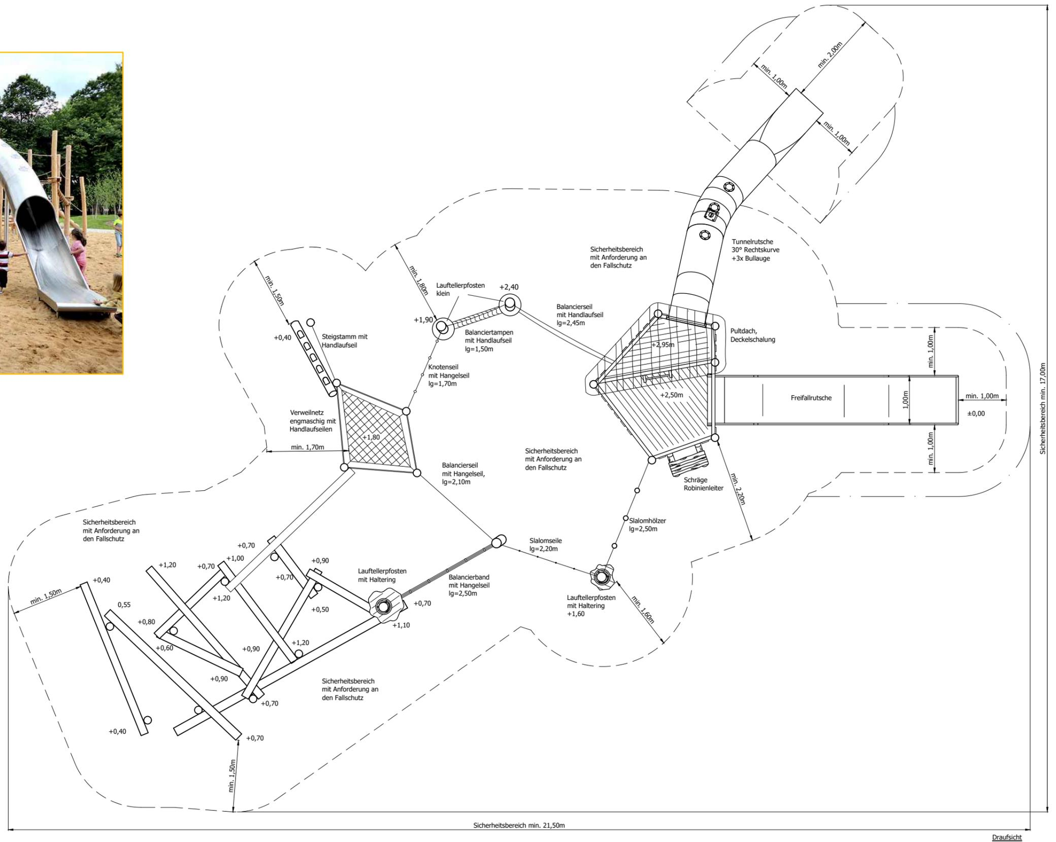
Maximale freie Fallhöhe des Gerätes: 2,95m
