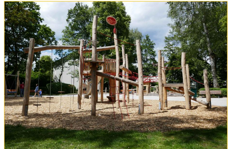
Maximale freie Fallhöhe des Gerätes: 2,95m
