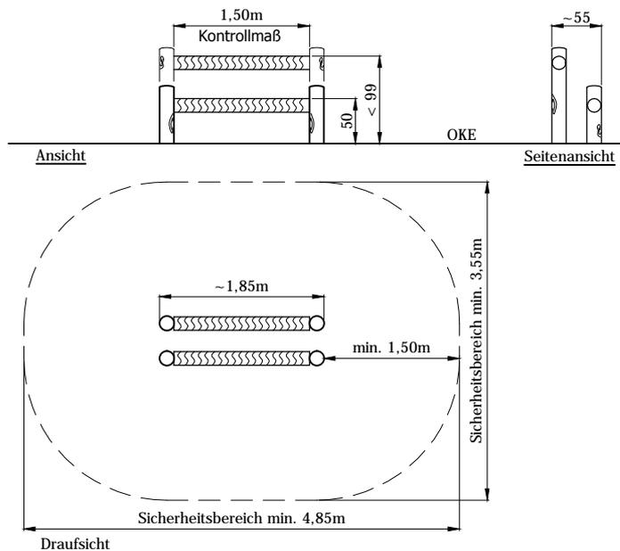
Maximale freie Fallhöhe des Gerätes: 0,99m
