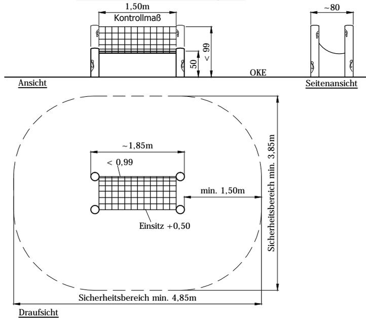
Maximale freie Fallhöhe des Gerätes: 0,99m
