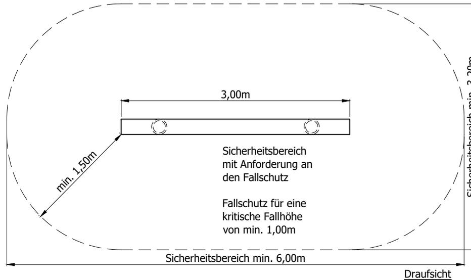
Maximale freie Fallhöhe des Gerätes: 0,50m
