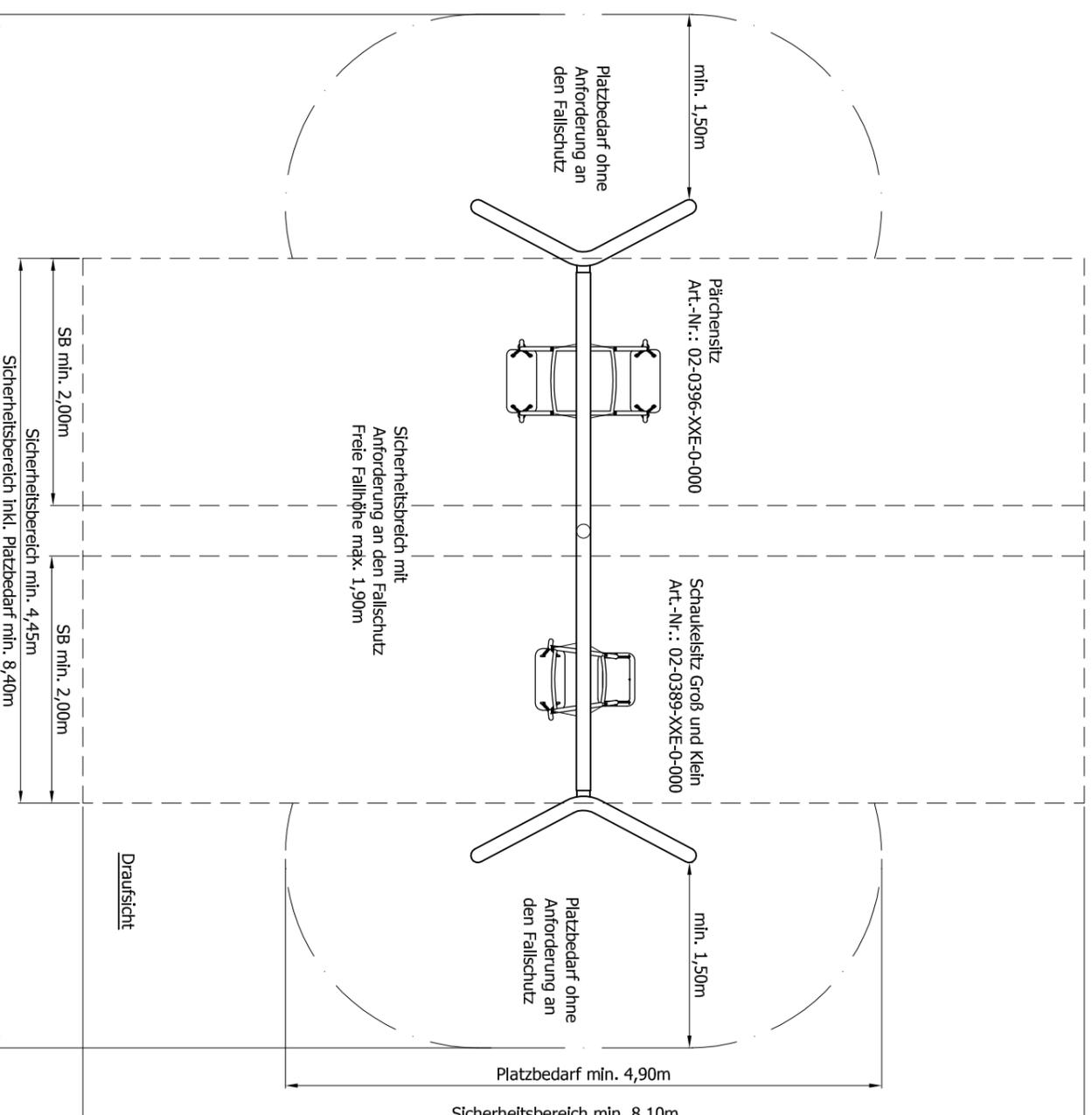
Maximale freie Fallhöhe des Gerätes: 1,90 m
