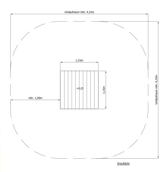
Maximale freie Fallhöhe des Gerätes: 0,25m
