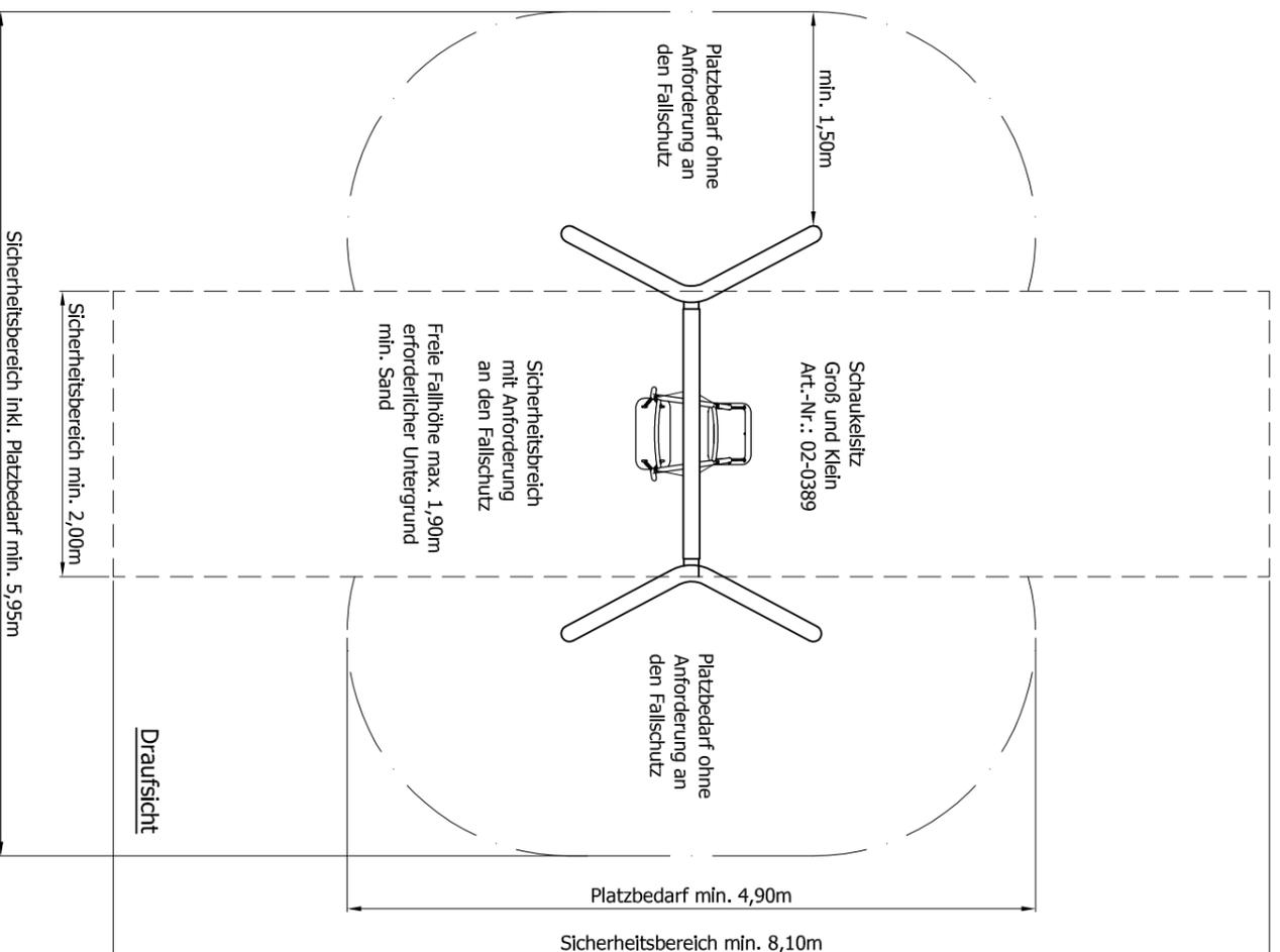
Maximale freie Fallhöhe des Gerätes: 1,90m
