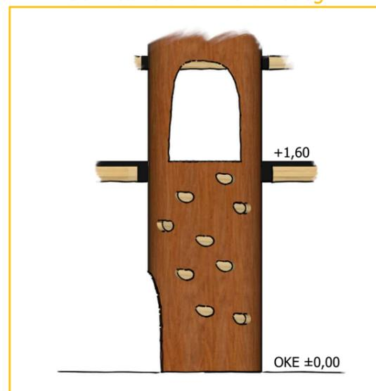
Maximale freie Fallhöhe des Gerätes: 1,60m
