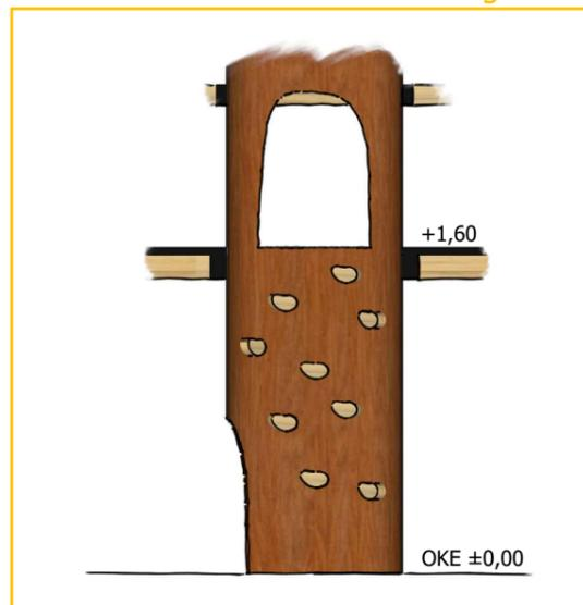
Maximale freie Fallhöhe des Gerätes: 1,60m
