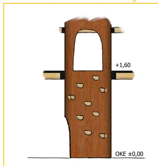
Maximale freie Fallhöhe des Gerätes: 1,60m
