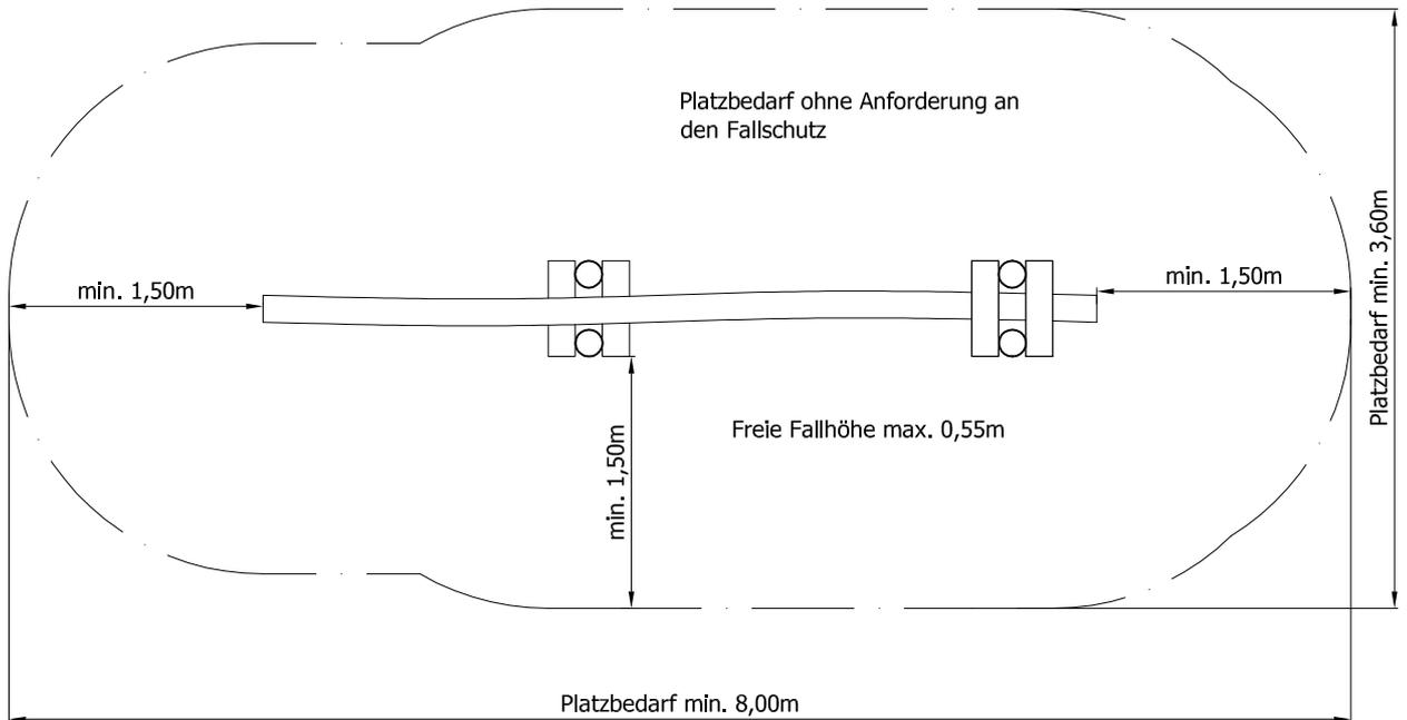
Maximale freie Fallhöhe des Gerätes: 0,55m
