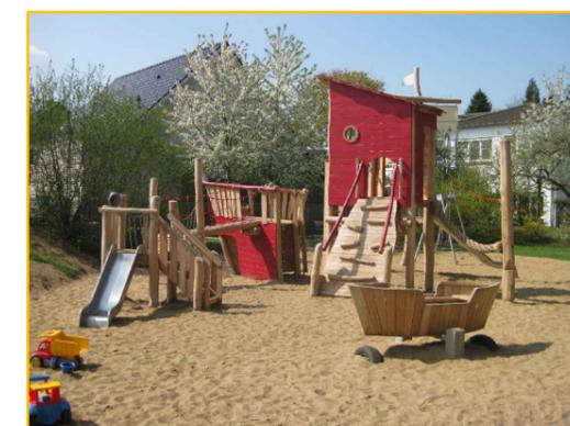
Maximale freie Fallhöhe des Gerätes: 1,90m
