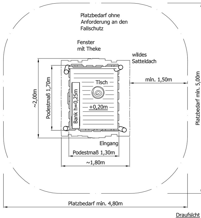
Maximale freie Fallhöhe des Gerätes: 0,20m
